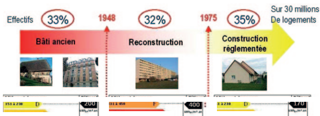
Performances thermiques en fonction du type de bâti, © Pierre d'Angle – (ANABF Sept. 2020)
